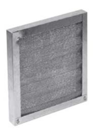
Фильтры воздушные ячейковые жироуловители ФВП предназначены для грубой очистки вытяжного воздуха от технологической пыли, масляных и жировых аэрозолей, удаляемых местными отсосами от кухонных плит в столовых, кафе, ресторанах, барах, а также вытяжной вентиляцией зданий и сооружений различных отраслей промышленности.
