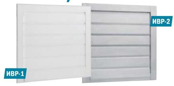
Инерционные решетки серии ИВР1 и ИВР2 с горизонтальным расположением подвижных жалюзи используются в системах приточно-вытяжной вентиляции и кондиционирования воздуха. Предназначены для монтажа в воздуховоды, строительные проемы и фасады зданий. Используются для удаления воздуха и автоматического перекрытия сечения воздуховода при выключенном вентиляторе.
